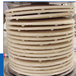
Déformation des cellules après traitement à la chaleur
