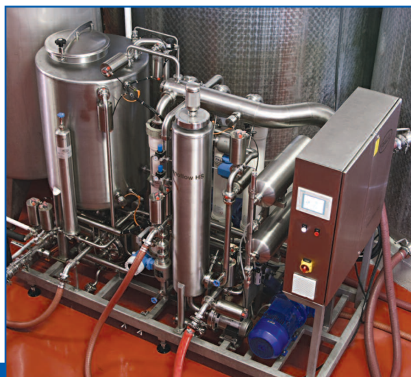
Sistema Oenoflow™ HS-4S instalado en Castellani
