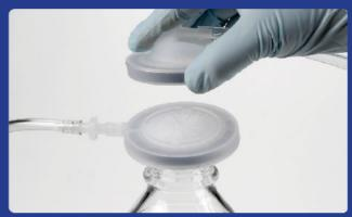
1.ホルダーベースをボトルの上に置き、メンブレンを清潔で乾燥したフィ ルターサポートの上に置きます。
