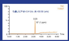
検出 – 質量分析計:ES+モード、質量範囲: 100.00-1400.0、カラム: Waters社 Acquity UPLC BEH 1.7 μm – 2.1x 50 mm、移動相A: 0.1%ギ酸含有メタノール、 移動相B: 0.01%ギ酸溶液、データ収録条件: グラジエント – 6.0 minutes
