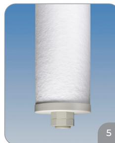
5. Atornille la primera tuerca de bloqueo en la rosca inferior del núcleo principal. Apriete lo suficiente para asegurar que los dos filos (superior e inferior) corten bien en el medio coalescedor. Atornille la segunda tuerca de bloqueo y apriétela para mantener la primera tuerca de bloqueo en su posición.
