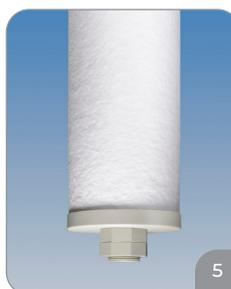
5. Visser le premier écrou de blocage sur le filetage inférieur du noyau principal. Serrer suffisamment pour s'assurer que les deux lames (haut et bas) pénètrent bien dans le milieu coalesceur. Visser le second écrou de blocage et le serrer afin de maintenir le premier écrou de blocage en place.
