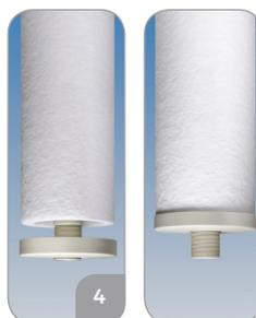
4. 小心地安装底板，确保刃状密封件正确安装在聚结器滤材上。底板的外壳必须覆盖聚结器滤材的外表面。
