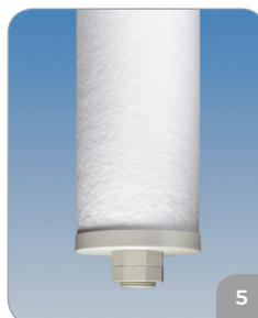
5. 将第一个锁紧螺母拧到主芯的底部螺紋上。拧紧以确保两个刃状密封件（顶部和底部）充分切入聚结器滤材。拧紧第二个锁紧螺母，并将第一个锁紧螺母固定到位。
